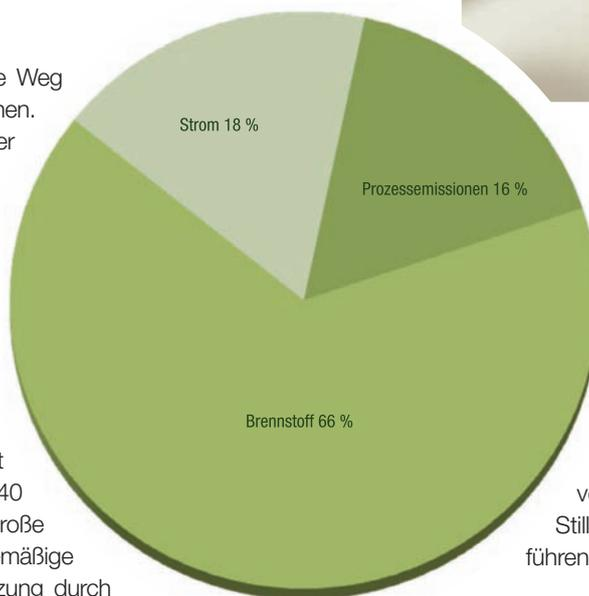
Abb. 6: CO<sub>2</sub>-Emissionen 2010 der Sektoren Ziegel und Dachziegel, feuerfeste Produkte sowie Wand- und Bodenfliesen (insgesamt 19Mt, das entspricht etwa 90 % der Emissionen der gesamten Keramikindustrie). Das Verhältnis der verschiedenen Emissionsarten, insbesondere Prozessemissionen, kann je nach Prozessen und Anlagen erheblich schwanken.
