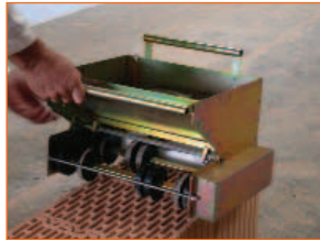
Planziegel mit VD Mörtelwalze
